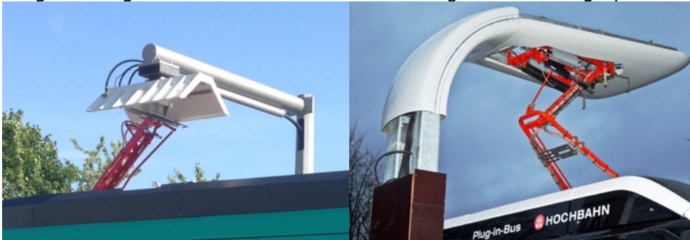
Abbildung 4: Docking-Stationen - Stromabnehmer am Fahrzeug (links) und Stromabnehmer an der Ladestation (rechts)
